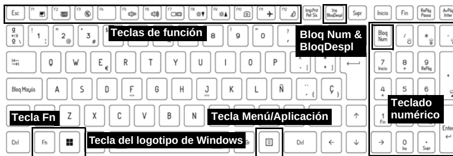
Figura 3 - (Opción de fábrica) Teclado con LED blanco de tamaño completo
