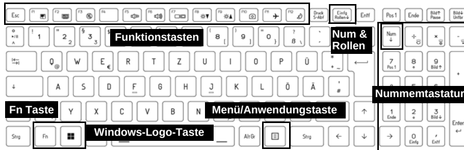
Abb. 3 - (Werkseitige Option) Weiße LED-Tastatur in voller Größe
