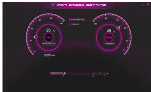
Figura 15 - Control de velocidad de FAN
