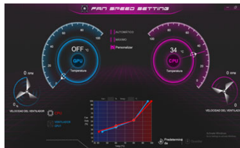
Figura 8 - Control de velocidad de FAN
