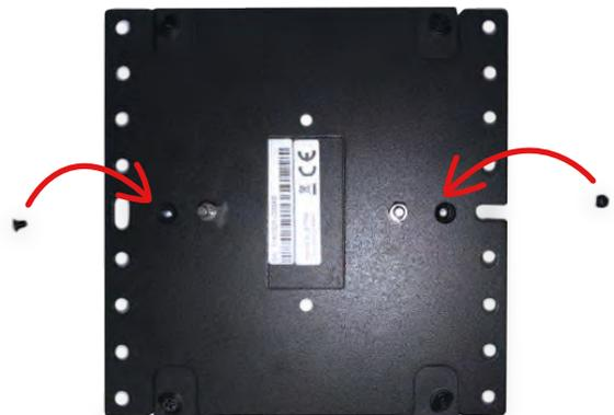
Die Platte mit 2 Senkkopfschrauben am Pokini F2 befestigen.
